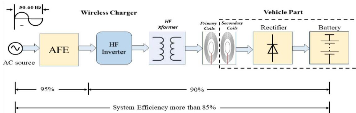
• FIG 6 :BLOCK DIAGRAM OF A WIRELESS CHARGING SYSTEM
