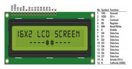
Fig6. LCD Display 16x2
