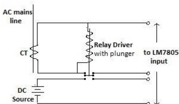
Fig. 3 Relay Circuit
