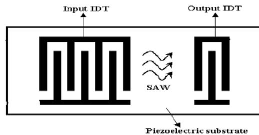
Fig. 1. SAW Device
