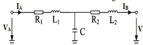
Fig.2. Lumped parameter model
