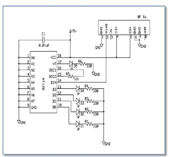
Fig 2. Decoder IC Pin Diagram
