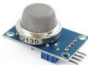
Fig.10 MQ135 Gas Sensor
