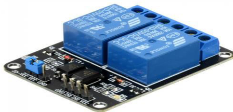
Fig. Relay module
