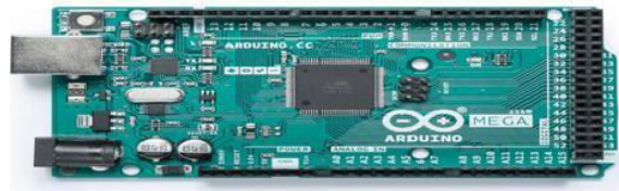
Fig. 2:Arduino microcontroller Mega
