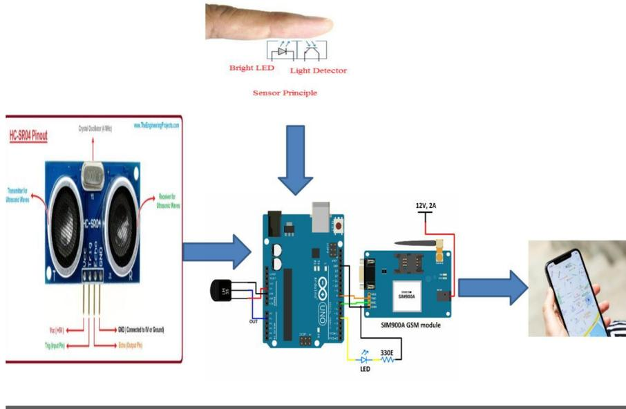
FIG2 :CIRCUIT DESIGN FOR VISUALLY IMPAIRED
