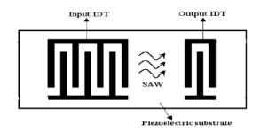
Fig. 1. SAW Device
